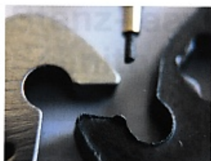
Bild 3: Der partiell anfallende Massivgrat wird prozesssicher entfernt und die gesamte Teilekontur bei einem autonomen Durchsatz von über 14.000 Teilen pro Stunde gleichmäßig verrundet
