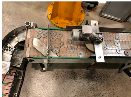
Bild Nr. 08-06 SY-AWB-FS-Band1.jpg Die Teile lassen sich in der Linie viel definierter transportieren
